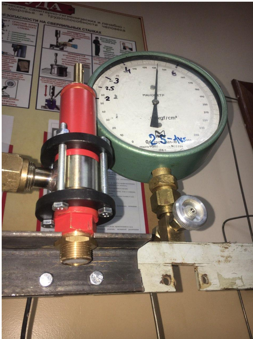
Рис 5.8 Запобіжний клапан експериментальний Тиск 5.2атм Клапан заквився!
