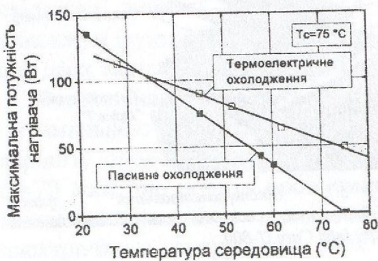
Рис. 7. Порівняння ефективностей термоелектричної та стандартної системи охолодження при різних температурах середовища.
