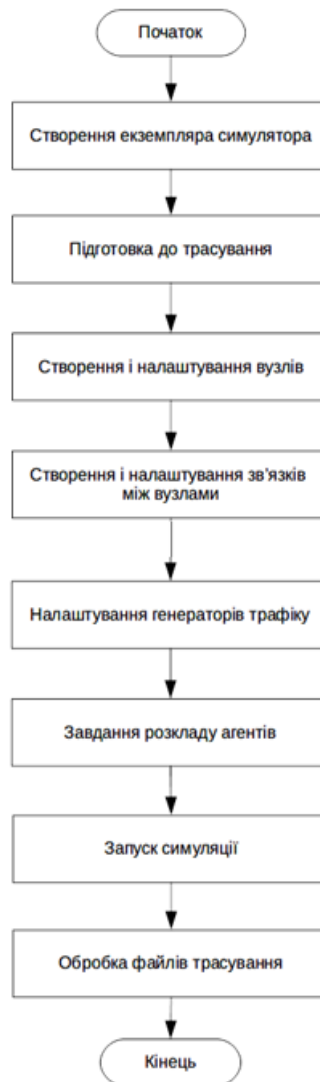
Рис. 1.4 Загальний алгоритм сценарію моделювання ІН в системі NS-2
