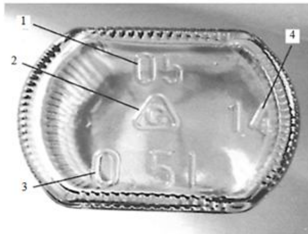
Рис. 2 Маркування скловиробів 1 — рік виготовлення; 2 — торговий знак; 3 — місткість; 4 — номер форми
