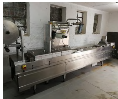
Рис. 3.3.11 – Термоформувальна пакувальна машина MULTIVAC R 230
