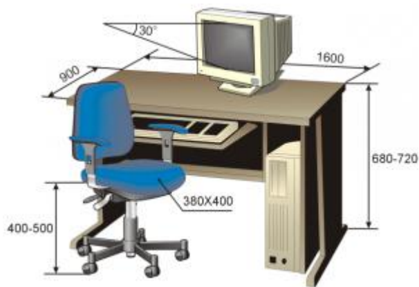
Рисунок 3.1. Конструкція робочого місця користувача ПК
