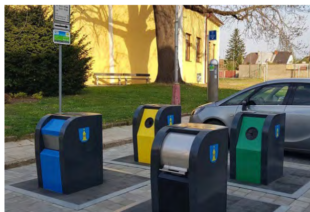
Рис. 1.2 – Контейнери з нижнім вивантаженням серії KTS/GFB/GFA для збору вторсировини та ТПВ, що завантажуються за допомогою крана маніпулятора [14].
