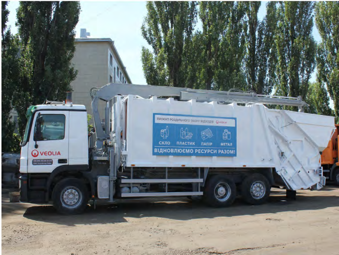
Рис. 1.4 – вТранспортний засіб для перевезення роздільно зібраних відходів компанії Veolia із можливістю завантажувати контейнери із нижнім вивантаженням
