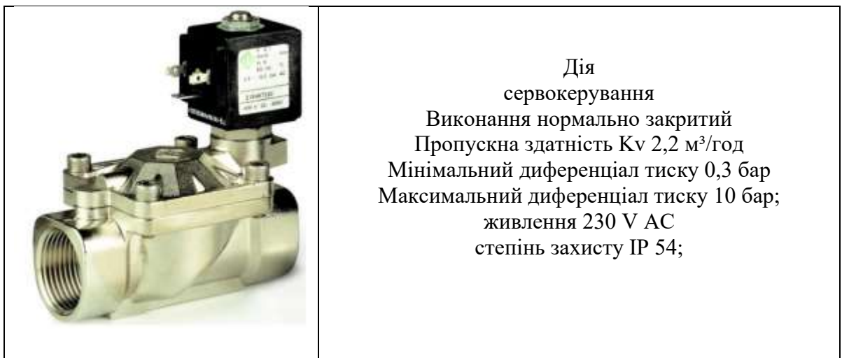
Рис. 5.6 Зовнішній вигляд та основні технічні характеристики клапану ODE 21X3KT190
