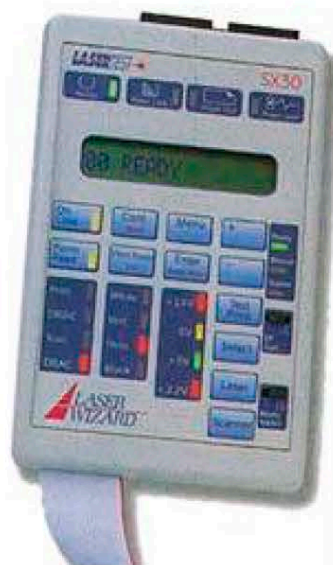
Рисунок 1.8. Тестер лазерних принтерів
