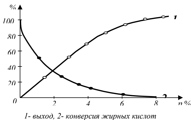
Рис.1 – Зависимость выхода «Стружка-2» от температуры при \tau=6 . Соотношение реагирующих компонентов жирных кислот: хлорид натрия: спиртовый раствор – 1:0, 5:0,5
