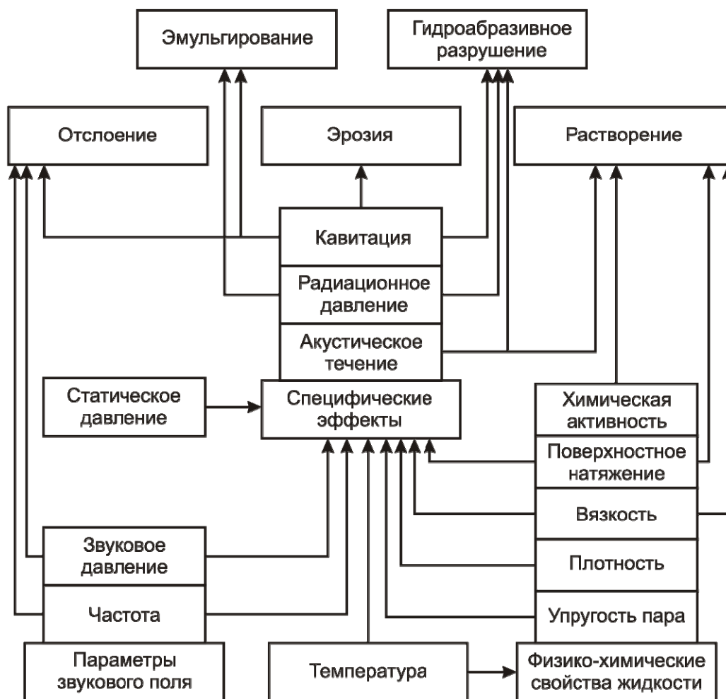
Рис. 1– Влияние различных факторов на механизм ультразвуковой очистки
