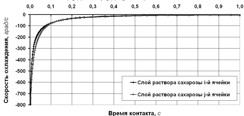
Рис. 7 – График зависимостей Ut_i^{cp}=f(t) , Ut_j^{cp}=f(t)
