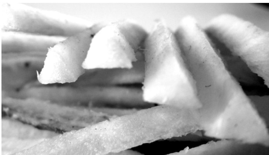
Рис. 4 – Бурякова стружка з трикутним поперечним перерізом
