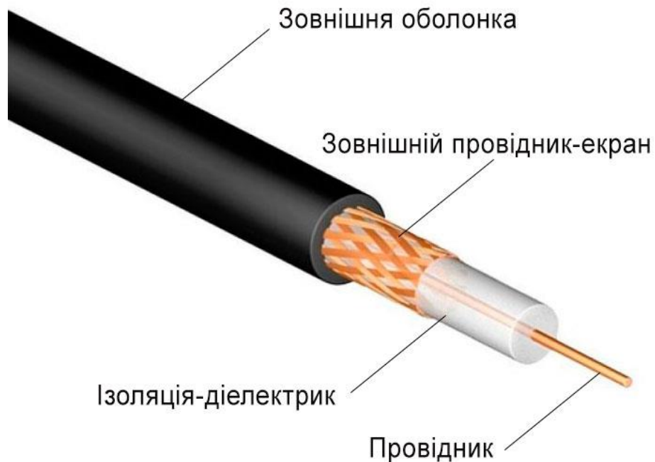
Рисунок 1.14 Структура коаксіального кабелю
