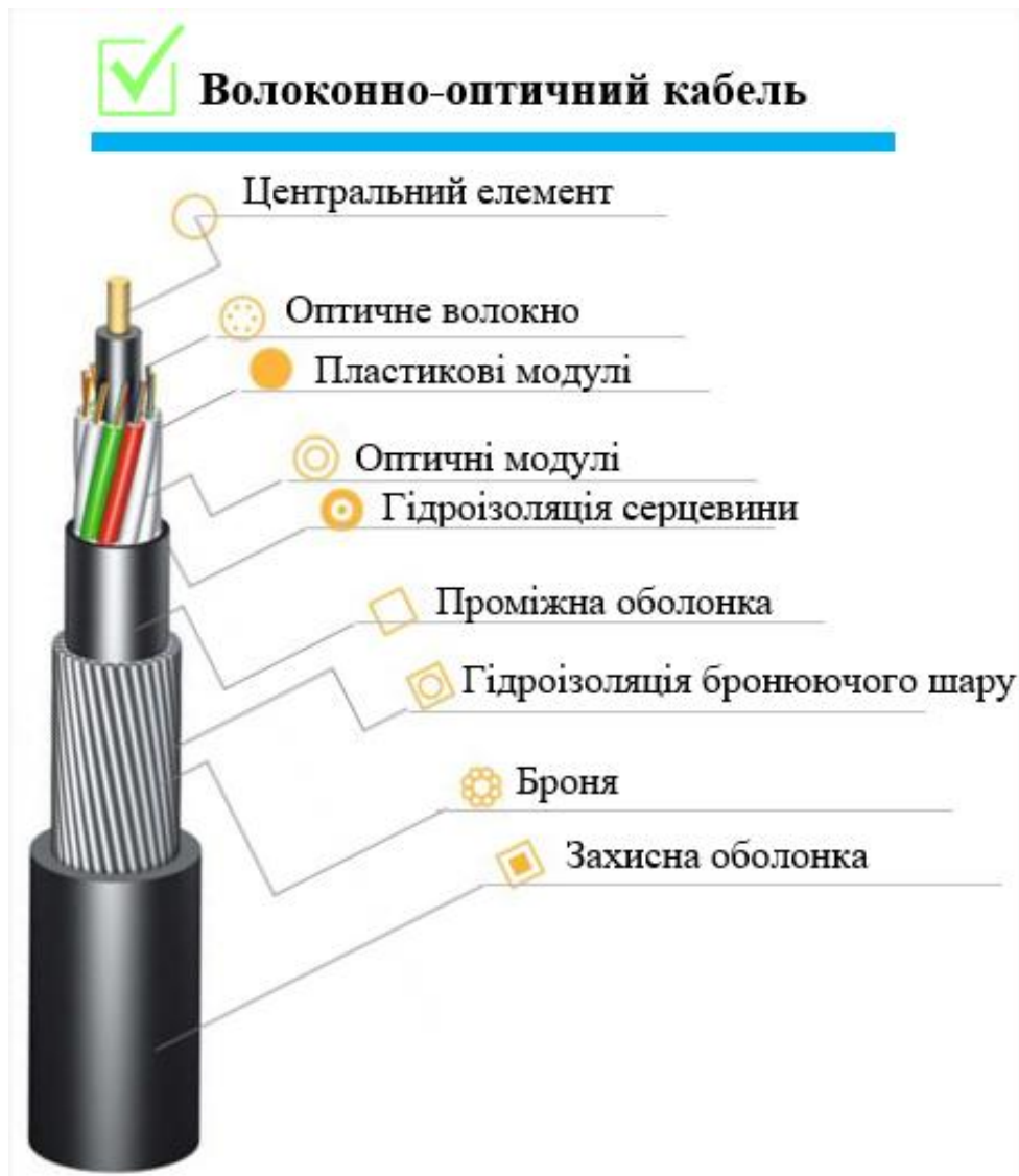
Рисунок 1.16 Структура оптоволоконного кабелю
