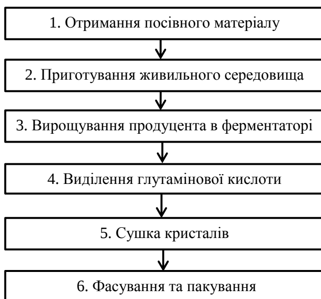
Рисунок 1.2 - Технологічна схема отримання глутамінової кислоти
