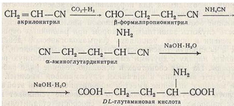
Рисунок 1.1 - Схема хімічного синтезу DL - глутамінової кислоти
