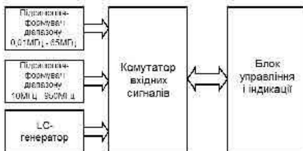
Рисунок 2.2. Структурна схема цифрового вимірювального приладу для визначення індуктивності, ємності та частоти
