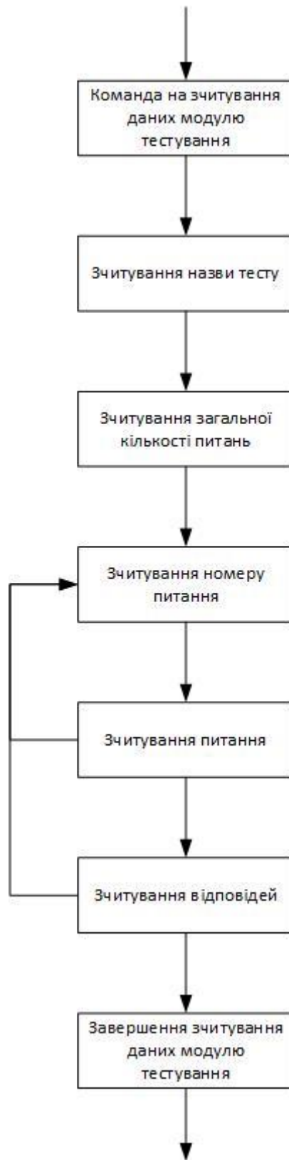
Рисунок 1.8. Схема процесу зчитування даних модулю тесту
