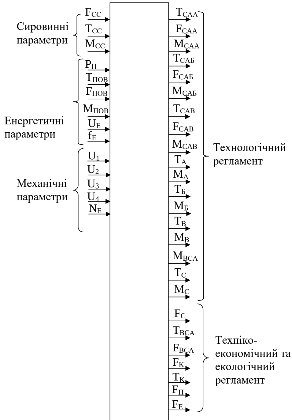
Рис. 1.4 – Параметрична схема процесу сушіння солоду
