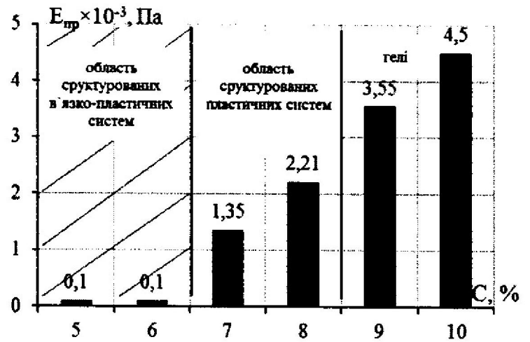
Рис. 5. Значення модуля пружності систем від вмісту БТ за температури 11±1°C.
