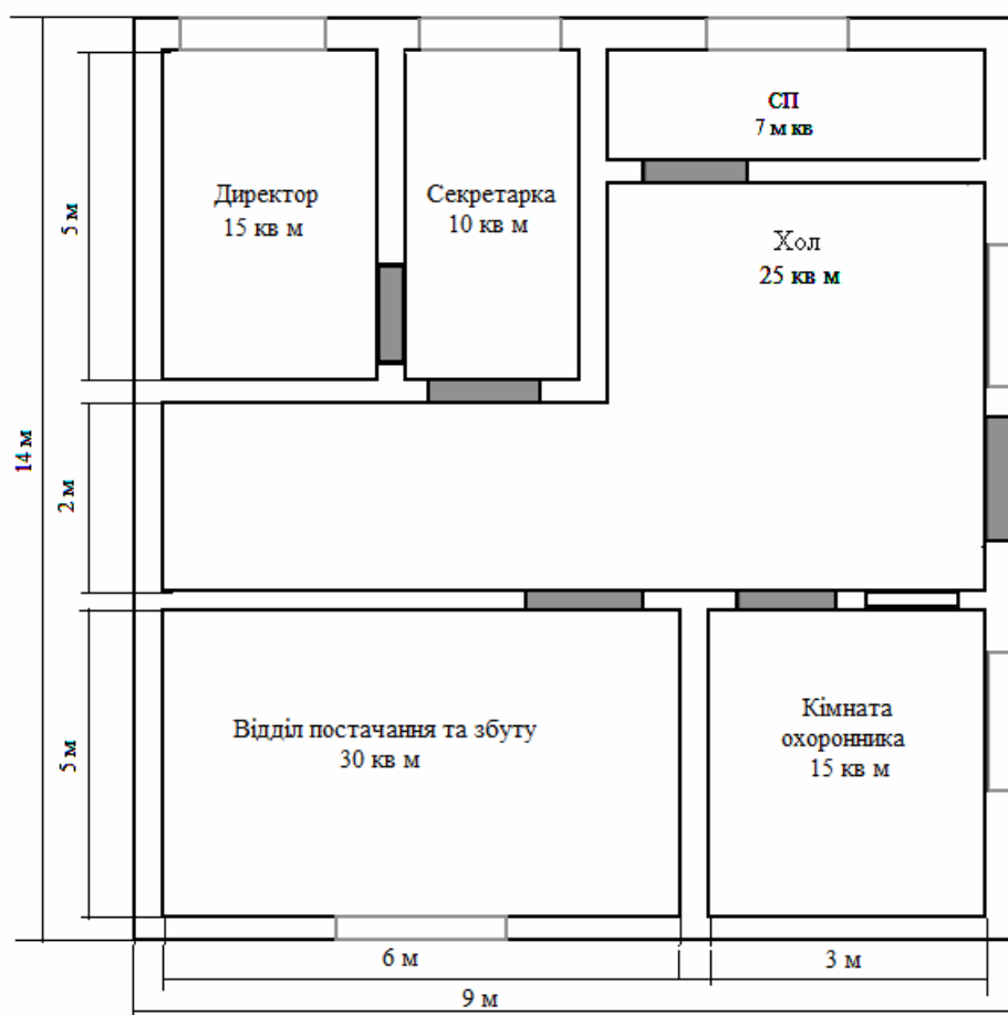
Рисунок 1.9. План офісу для розміщення системи сигналізації
