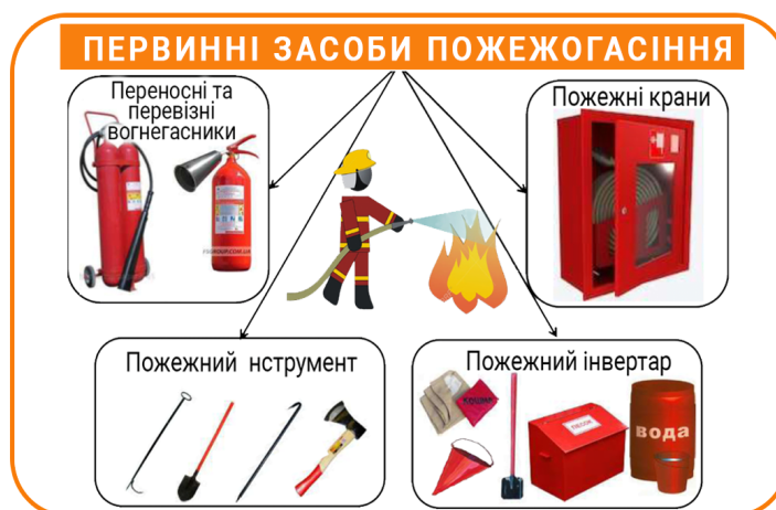
Рисунок 3.2. Первинні засоби пожежогасіння
