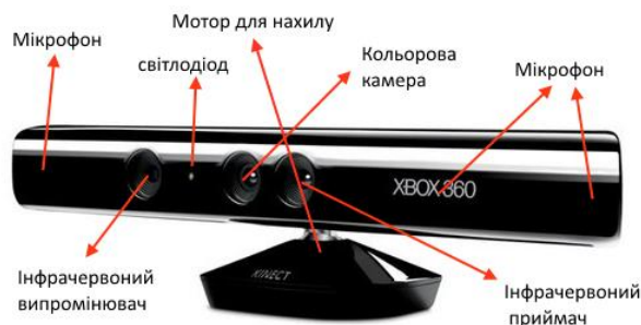
Рисунок 1 – Структура Kinect
