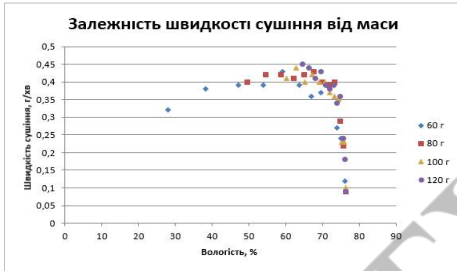
Рис. 2 – Залежність швидкості зневоднення яблучних вичавків від вологості
