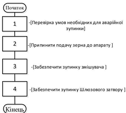
Рис. 4.6 – Блок-схема регламенту функціонування процесу гідротермічної обробки крупи в камері пропарювання
