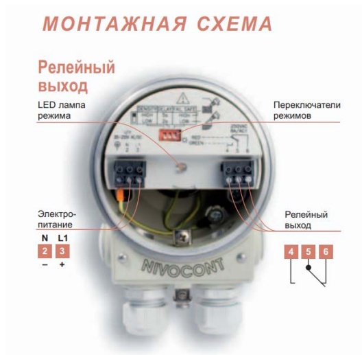
Рис. 5.8 – Схема підключення датчику рівня NIVOCONT R
