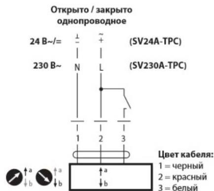
Рис. 5.17 – Схема підключення електропривода Belimo SV24A-TPC
