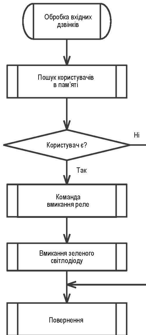
Рисунок 1.39. Блок-схема алгоритму обробки вхідних дзвінків
