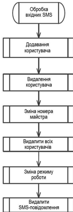
Рисунок 1.38. Блок-схема алгоритму обробки вхідних SMS
