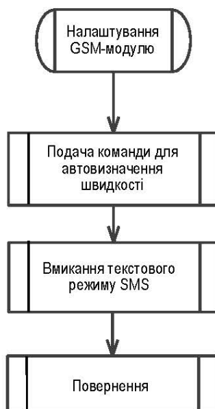
Рисунок 1.37. Блок-схема алгоритму налаштування GSM-модуля
