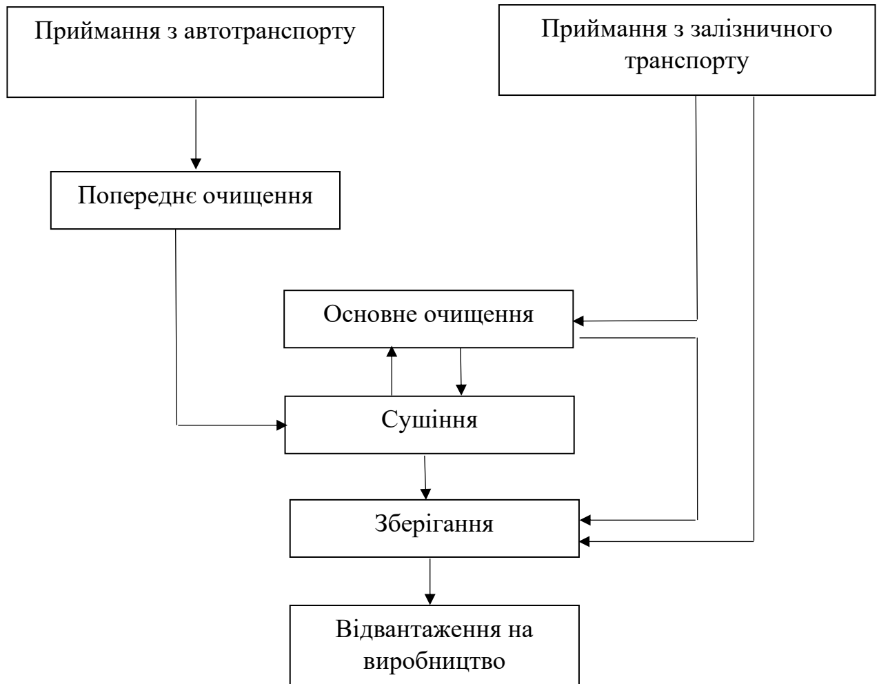
Рисунок 3.1 – Структурна схема роботи елеватора.
