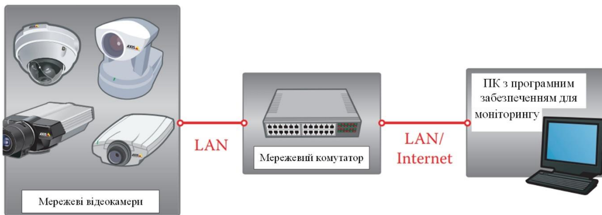
Рисунок 1.11. Структурна схема роботи мережевої відеосистеми з мережевими відеокамерами
