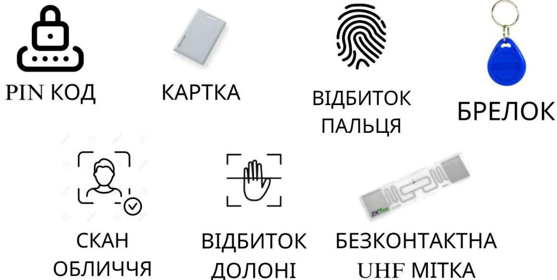
Рисунок 1.13. Приклади ідентифікаторів доступу користувачів СКУД
