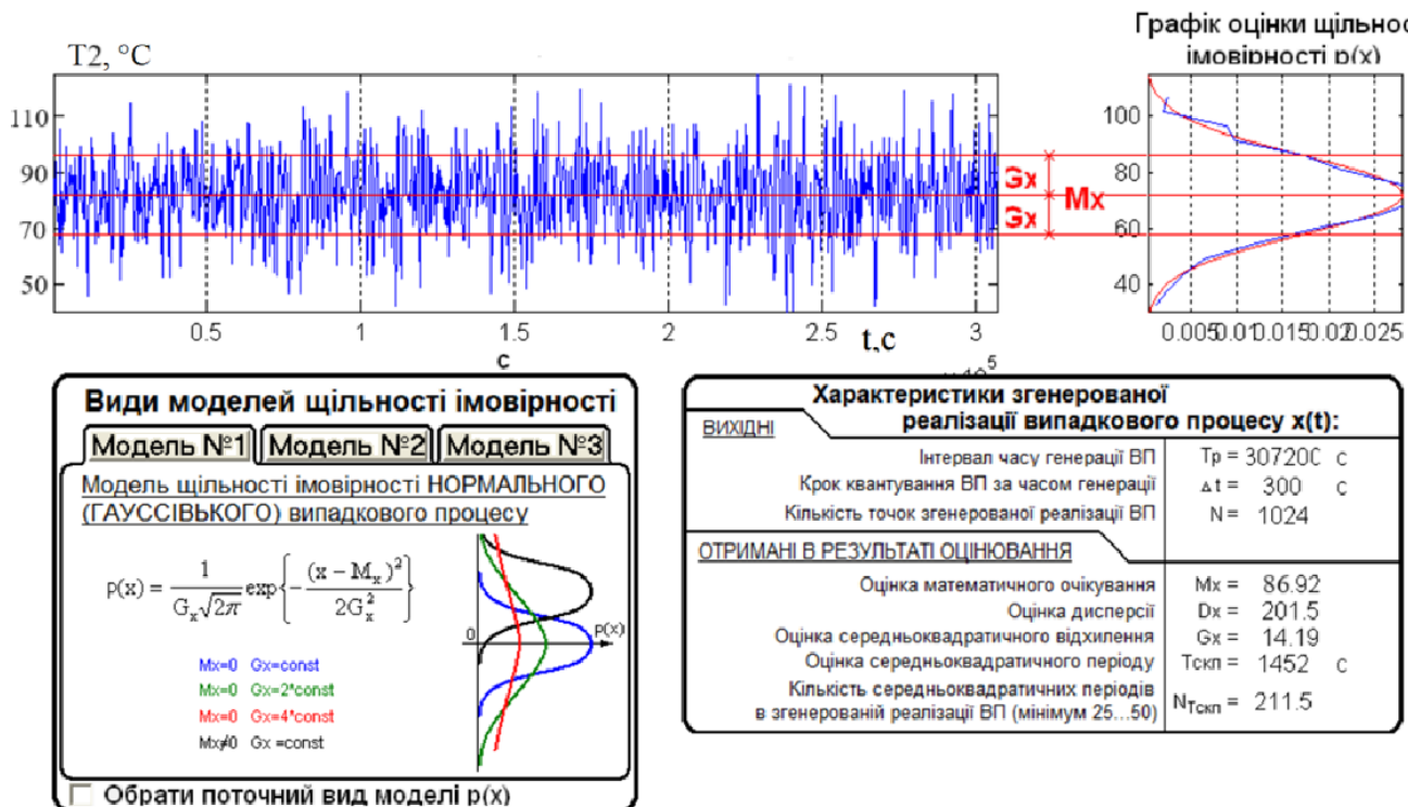
Рис. 2.39- Результат моделювання неконтрольованих збурень із корегованими параметрами формуючого фільтра.
