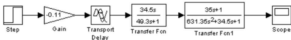
Рис. 3.19 – Структурна схема моделювання передавальної функції коригувального зв'язку
