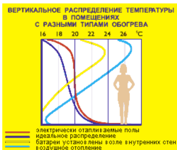
Рис. 5.1 Розподіл температур в приміщеннях з різними типами обігріву
