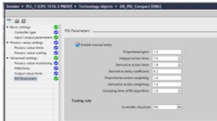
Рис. 6.20 – Приклад налаштування параметрів ПІД-регулятора
