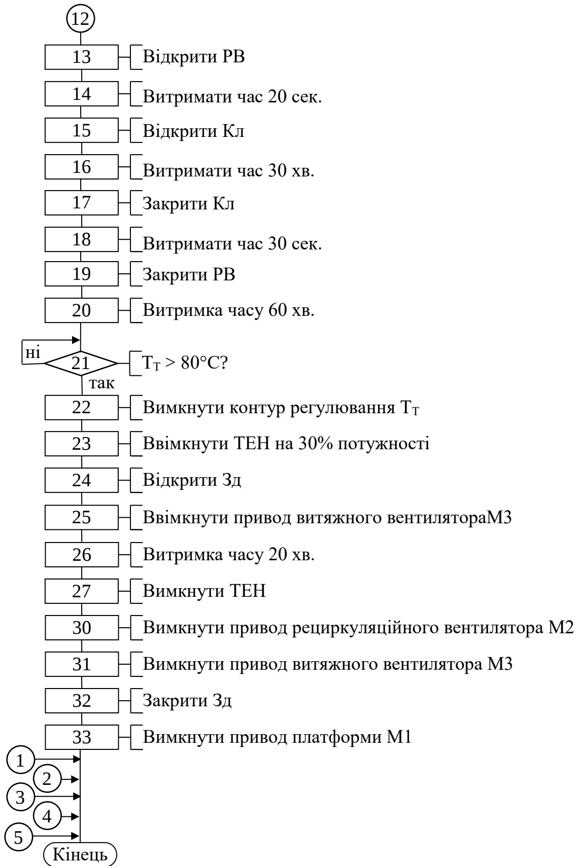
Рис. 4.4 (закінчення) – Блок схема алгоритму автоматичного керування циклом гарячого бездимного копчення риби в універсальній коптильній камері
