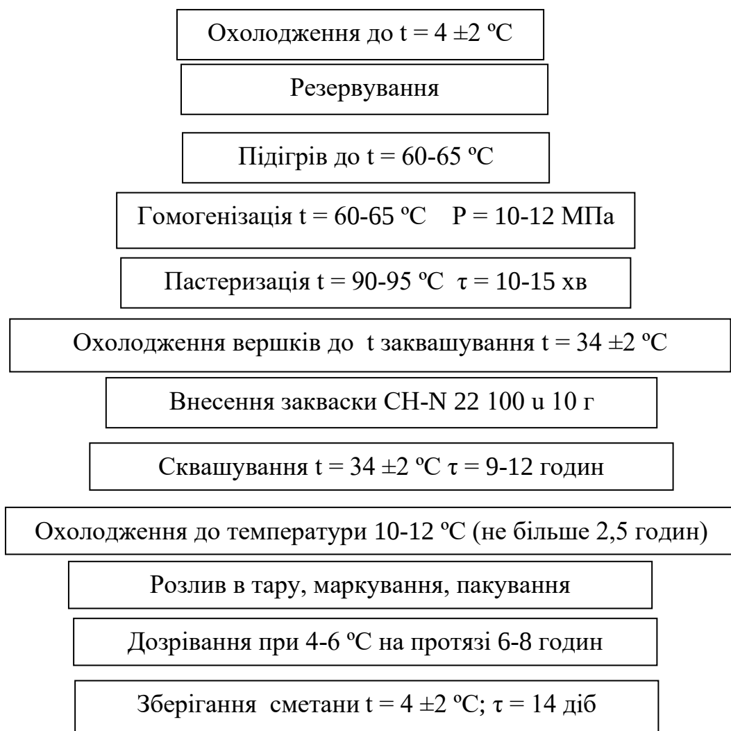
Рис. 2.5 Технологічна схема виробництва сметани резервуарним способом
