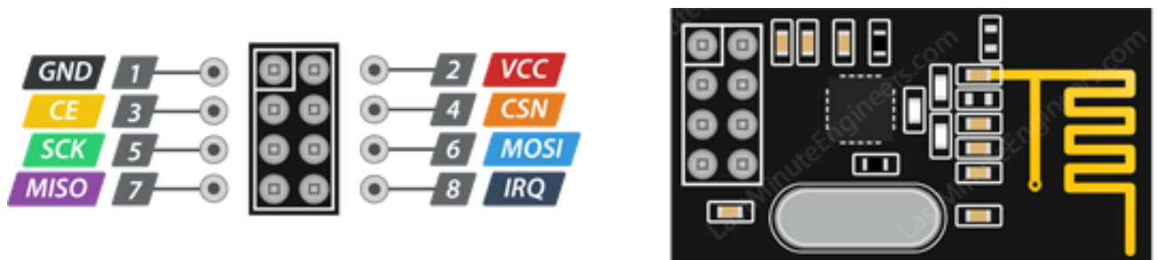
Рисунок 1.14. Зовнішній вигляд та підключення радіомодулю SE8R01
