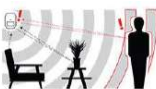
Рисунок 1.6 – Принцип роботи комбінованих датчиків руху
