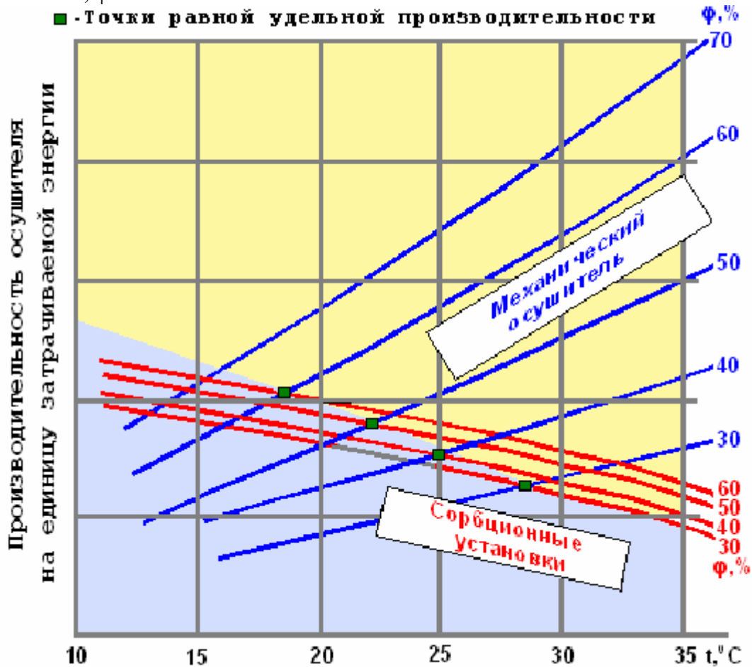
Рис. 2.2 Залежність робочих характеристик осушувальних установок від температури при різних значеннях відносній вологості повітря.
