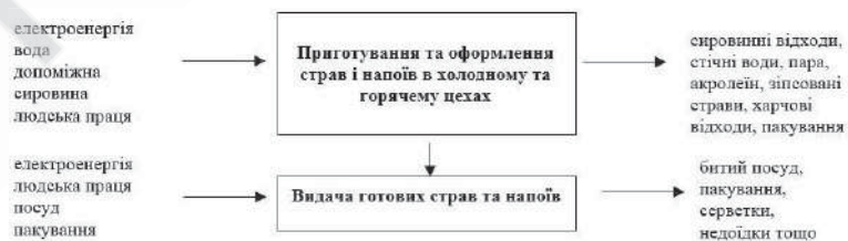
Рис. 4 - Схема аналізу життєвого циклу приготування та оформлення страв і напоїв в холодному та гарячому цеху
