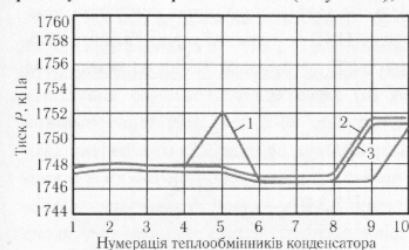
Рис. 13. Характер зміни тиску в колекторі рідкого аміаку в залежності від алгоритмів роботи вентиляторів: 1 — шаховий; 2 — непарний; 3 — парний
