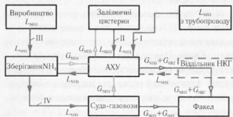
Рис. 1. Блок-схема комплексу перевантаження аміаку: I — \text{NH}_3 з аміакопроводу; II — \text{NH}_3 , що надходить на завод в залізничних цистернах; III — \text{NH}_3 власного виробництва; IV — \text{NH}_3 , що відвантажуються на судна-газовози
