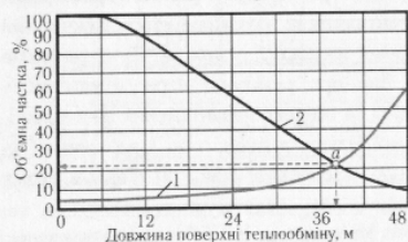
Рис. 14. Вплив НКГ (1) на процес конденсації аміаку (2) в теплообміннику
