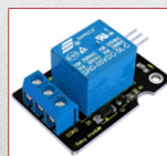
Модуль реле 5B Low Level (220V 10A)
