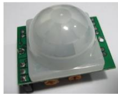
Рисунок 1.10. Інфрачервоний датчик із лінзою Френеля
