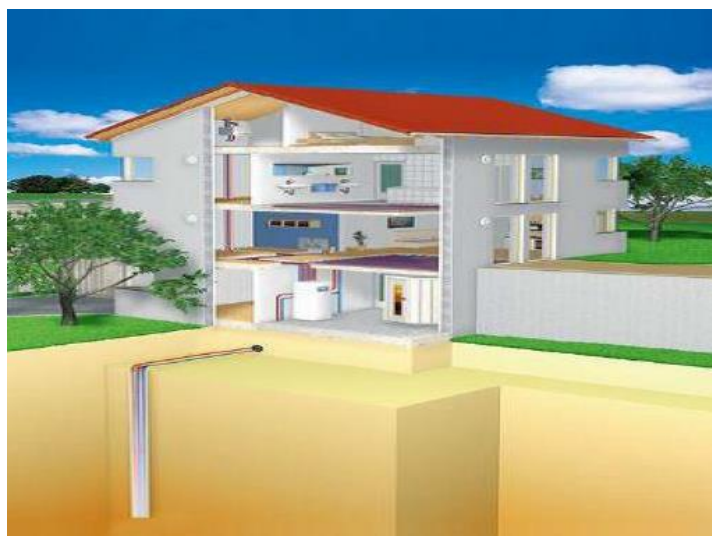
Рисунок 2.11 - Схема теплообміну закритого способу і вертикальним теплообмінником
