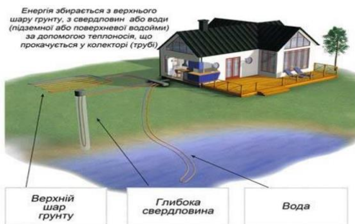
Рисунок 2.7 - Принцип відбору геотермального тепла
