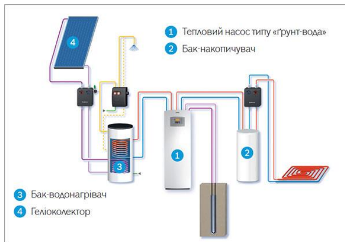
Рис 5.1 Комбінована система тепло- та холодозабезпечення
