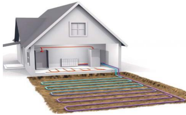
Рисунок 2.10 - Схема теплообміну закритого способу
