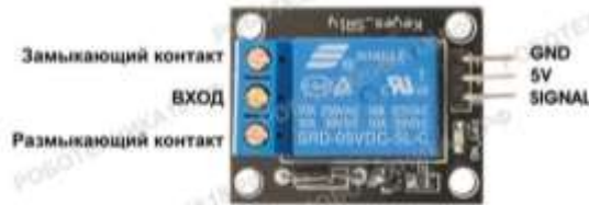
Рисунок 1.19 – Модуль реле SRD-05VDC-SL-C (розпіновка)
