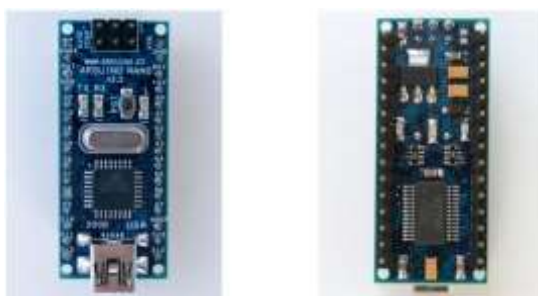
Рисунок 1.4 – Зовнішній вигляд Arduino Nano (вид спереду та ззаду). Нижче наведено характеристики Arduino Nano [9].
