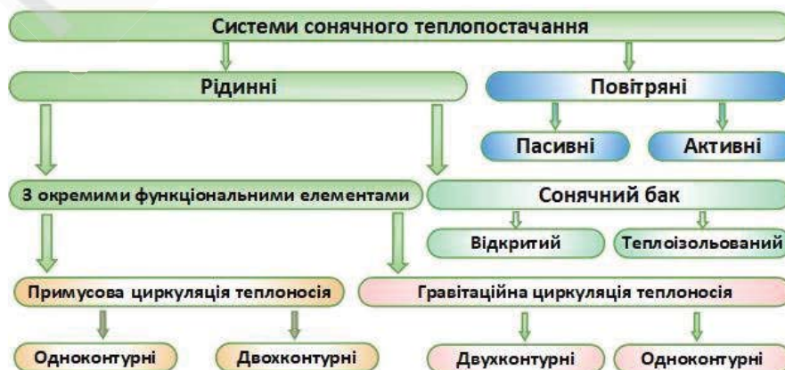
Рис. 1. Класифікація систем сонячного теплопостачання
