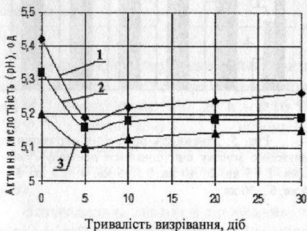
Рис. 6. Залежність зміни активної кислотності сирної маси виготовленої з молока після ВТ обробки від тривалості визрівання, кількості і складу бактеріальної закваски: 1 – (0,7+0,1) %, 2 – (1,5+0,3) %, 3 – (2,0+0,5) %.
