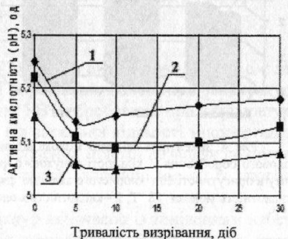
Рис. 7. Залежність зміни активної кислотності сирної маси виготовленої з молока після УВТ обробки від тривалості визрівання, кількості і складу бактеріальної закваски: 1 – (0,7+0,1) %, 2 – (1,5+0,3) %, 3 – (2,0+0,5) %.
