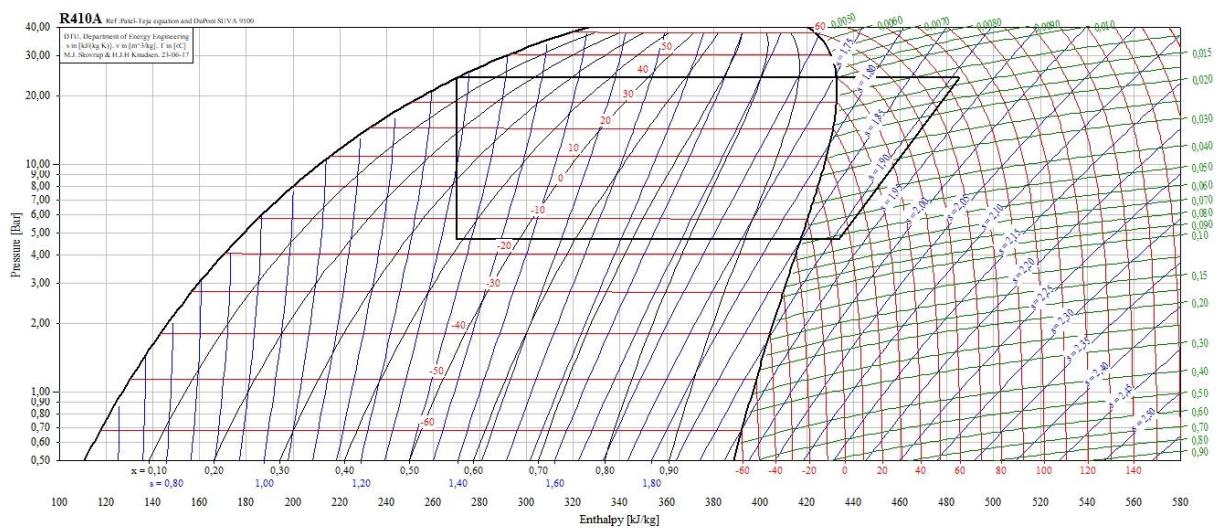
Рис.3.9 Цикл роботи енергетичної установки системи кондиціонування повітря фітнес центру на -16°C.
