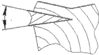
Рис.2.Взаємне розташування ножа і продукту.
