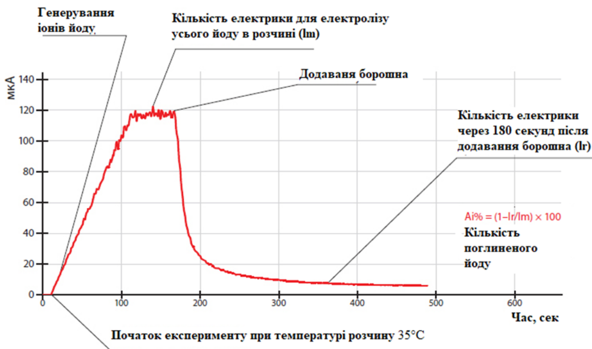
Рис. 4.3 – Принцип вимірювання приладу SDMatic
