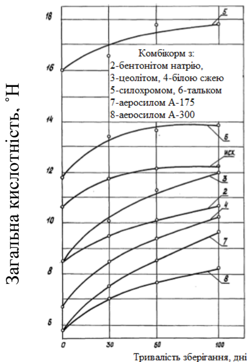
Рис. 12 - Зміна загальної кислотності комбікорму з ПДСО та різними наповнювачами від тривалості зберігання ( \varphi = 80\% , t = 19,5 \pm 2,5^\circ\text{C} )
