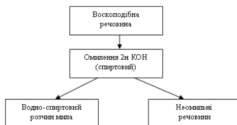
Рис.1 – Схема проведення аналізу з визначення складу неомильних речовин
