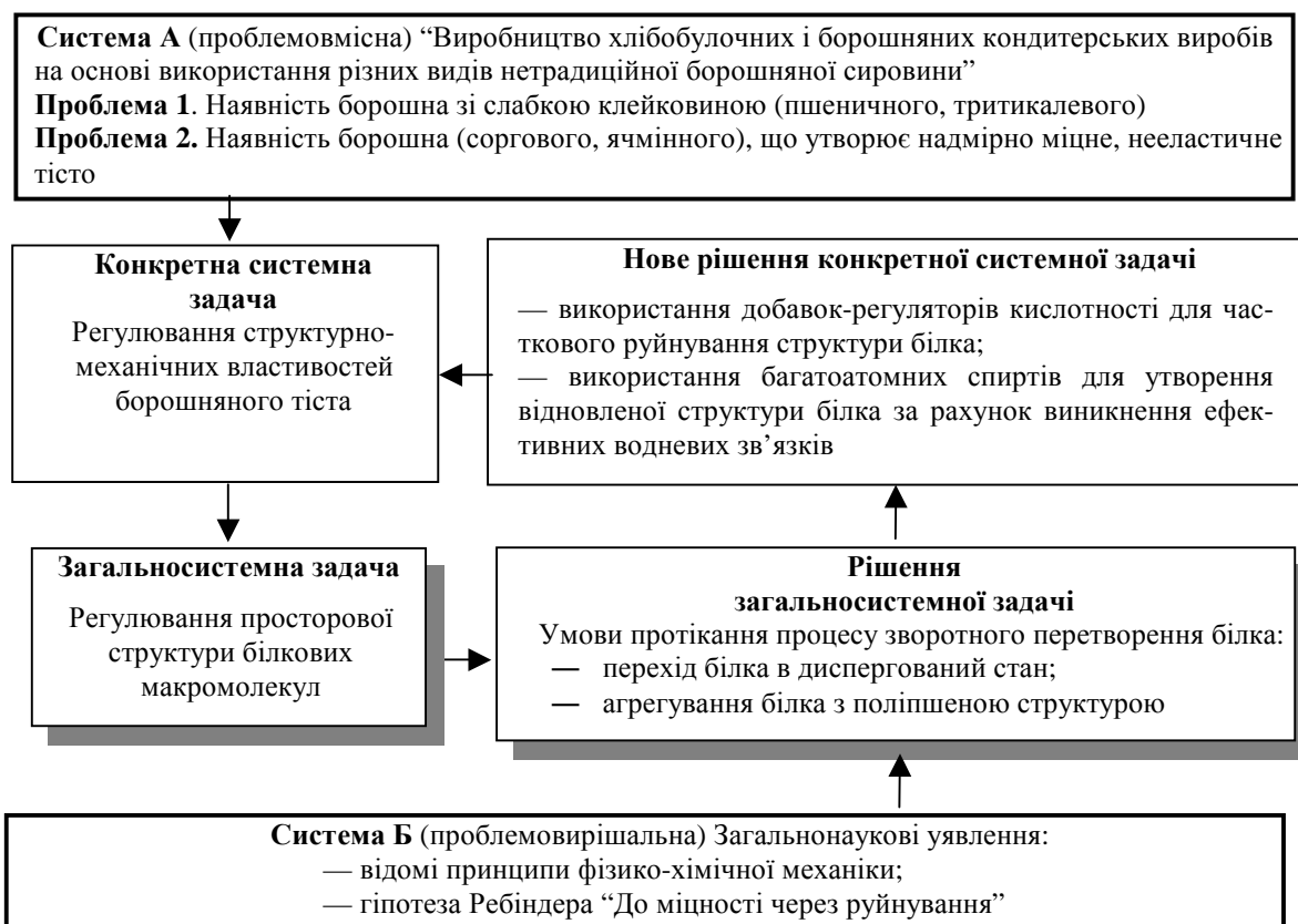
Рис. 3 – Алгоритм вирішення конкретної системної задачі регулювання структурно-механічних властивостей борошняного тіста
