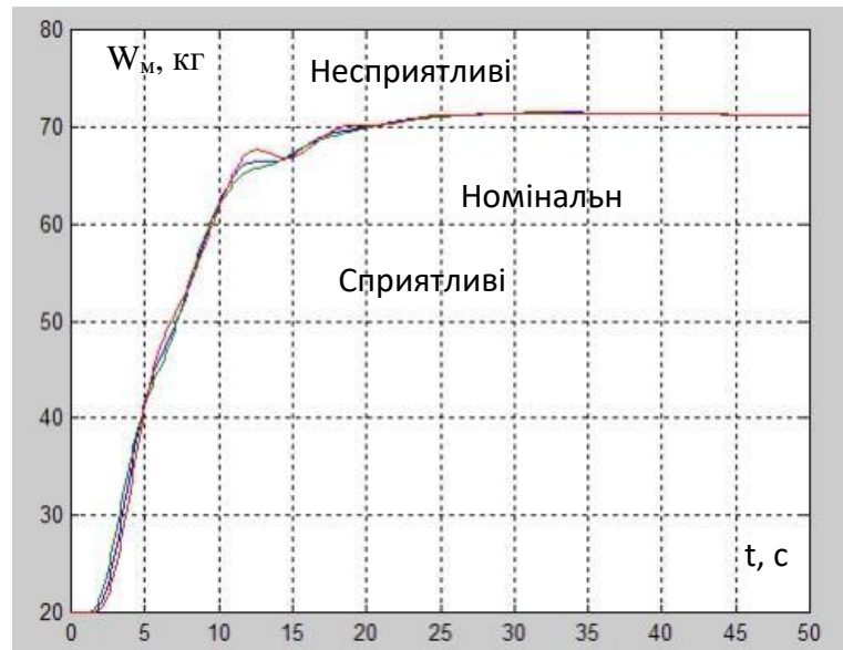
Рис. 3.1.11 – Результати порівняння варіантів САР по каналу « u - W_M » з різними значеннями часу запізнення ОК
