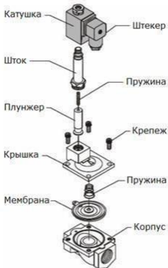
Рис.5.19 - Конструкція електромагнітного клапана
