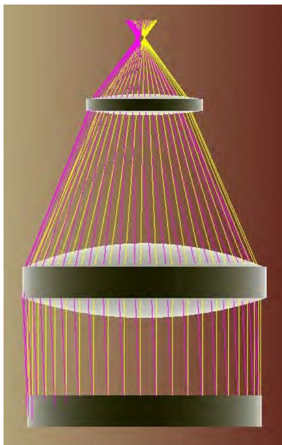
Рисунок 1.14. Візуалізація тіньової моделі оптичної системи у Zemax
