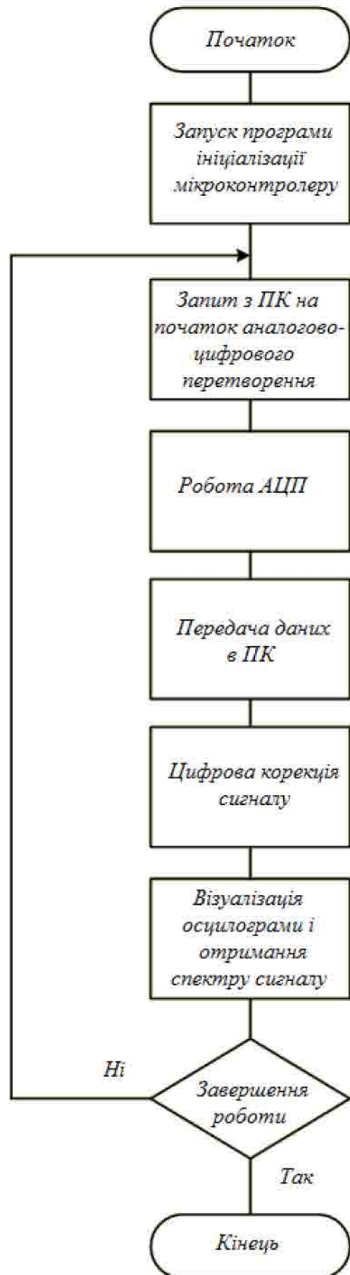
Рисунок 1.13. Блок-схема алгоритм роботи мікроконтролера приладу для вивчення форми електричних сигналів
