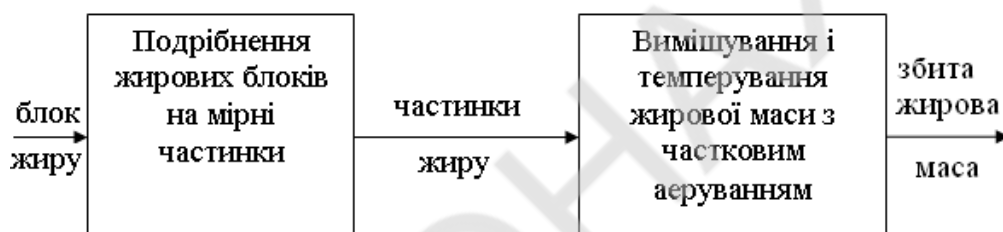
Рис. 1. – Структурна схема технологічного процесу у ВВ-ПМЛ
