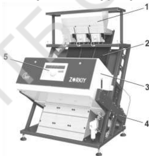
1 – приймально-розподільний пристрій; 2 – лоток з каналами; 3 – фотоелектронний блок з пневматичною системою вилучення домішок; 4 – станина; 5 – дисплей для контролю і управління.
