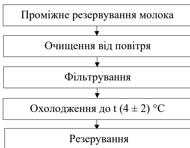
Рис. 2.3 – Технологічна схема первинної обробки молока
