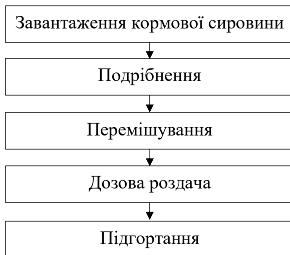
Рис. 2.1 – Технологічна схема приготування та роздачі кормів TMR
