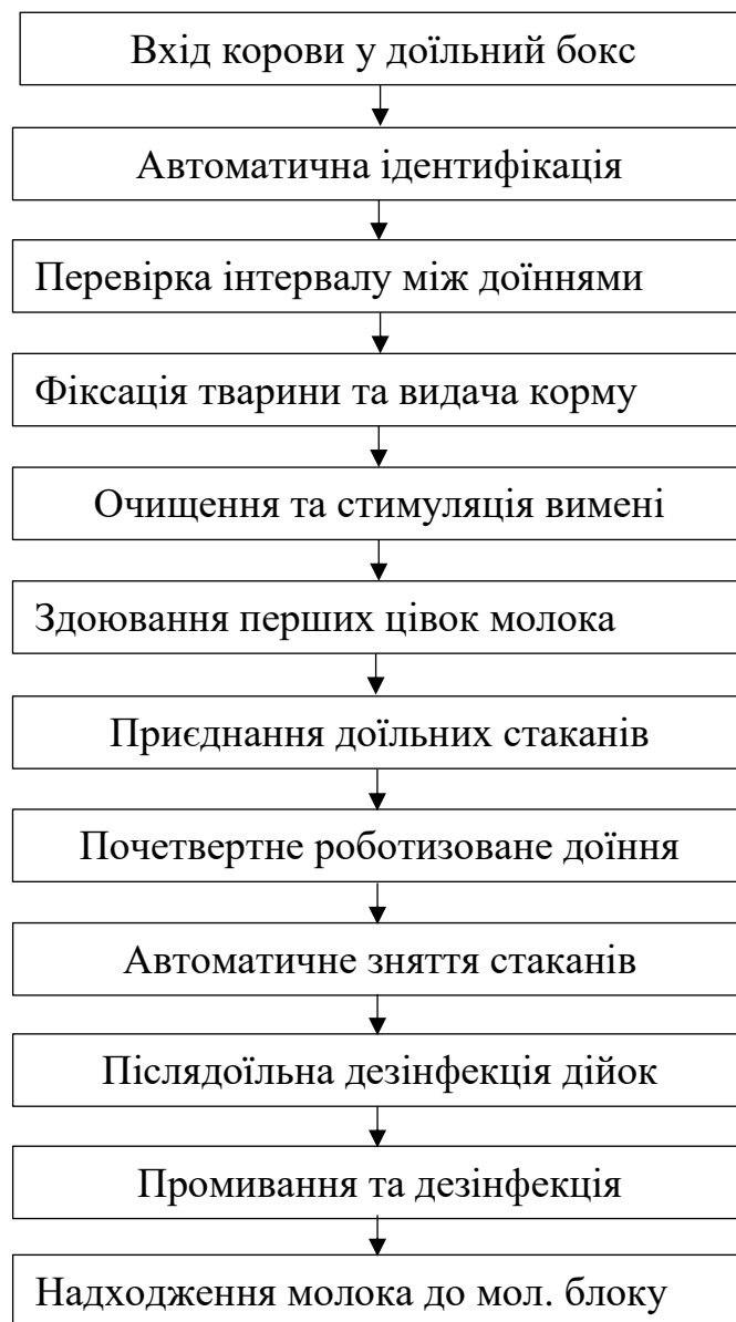
Рис. 2.2 – Технологічна схема роботизованого доїння
