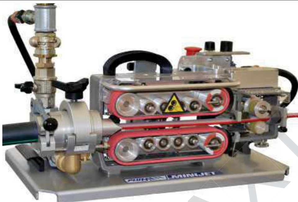
Рис 4. Пристрій для розміщення кабелів у труби фірми SHERMAN+REILLY™ (USA), модель Minijet® [3]
