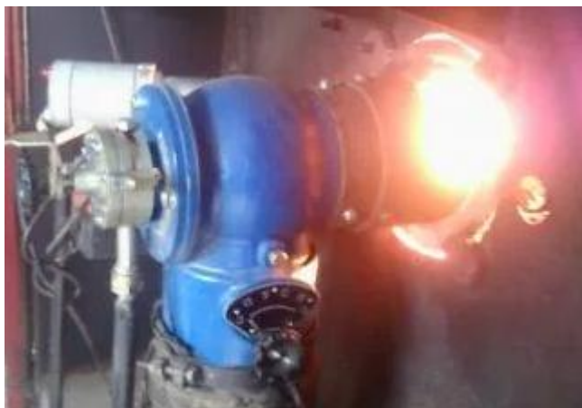
Рис.5.8 Форсунка Ф-1 для подачі горючої суміші
