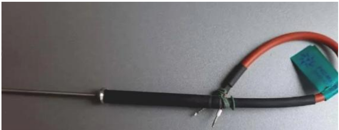
Рис. 5.1 - Погружной термоперетворювач ТСП-106 Pt100.
